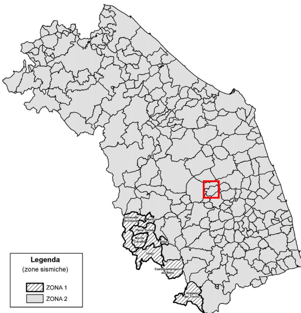
Fig.4 – Regione Marche, classificazione sismica (DGR n. 1142 del 19 settembre 2022). Nel riquadro in rosso viene indicata l'ubicazione del territorio comunale di Colmurano.
